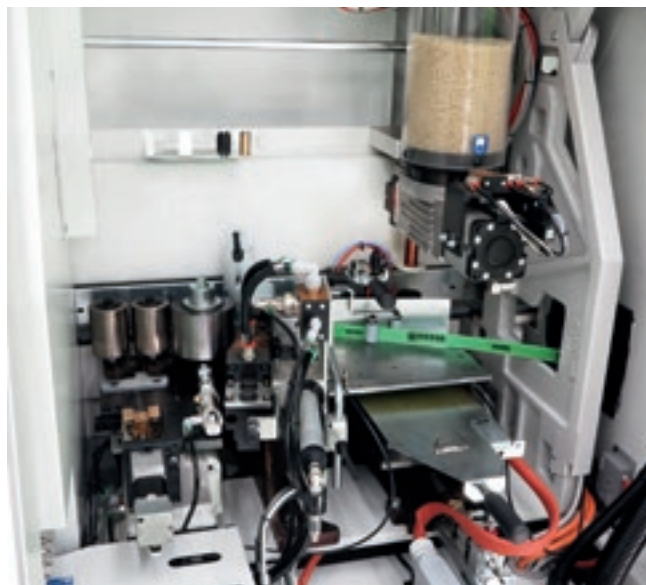
Клеевая группа для автоматического нанесения кромки в рулонах или полосках, толщиной от 0,4 до 12 мм.
